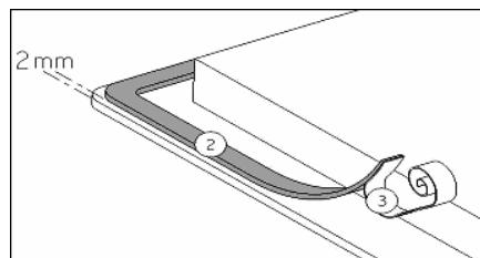
Collez le joint (2) à deux millimètres du bord extérieur du verre après avoir retiré le film de protection.
