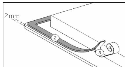
Plak de afdichting (2) twee millimeter van de buitenste rand van het glas verwijderd, nadat u de beschermfolie hebt verwijderd.
