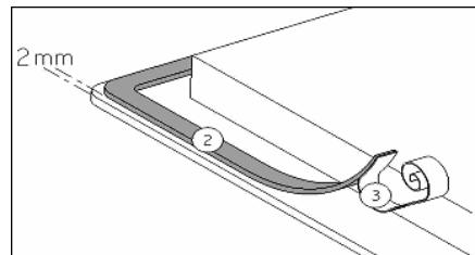
Pegue la junta (2) a dos mm del borde exterior del cristal, una vez retirada la lámina protectora.
