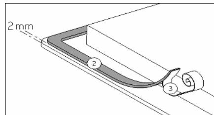
Kleben Sie die Dichtung (2) zwei Millimeter vom äußeren Rand des Glases entfernt, nachdem Sie die Schutzfolie entfernt haben.
